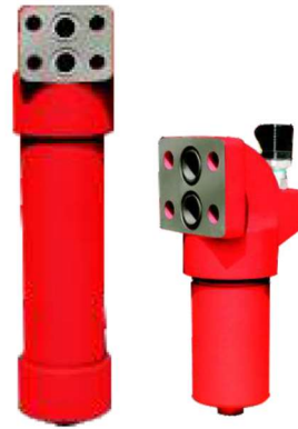
DF AFE QE 高压过滤器 流量: 60-1320L/min 过滤精度: 3-200 μm 压力等级: 315bar
