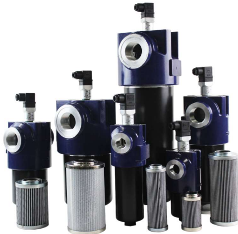
LF 管路过滤器 流量: 60-660L/min 过滤精度: 3-200 μm 压力等级: 100bar
